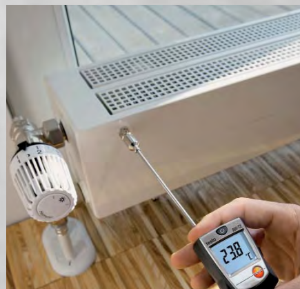
Měření povrchové teploty radiátorů.
