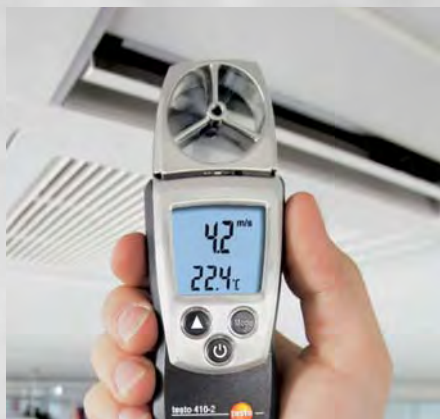
Měření na výstcích pomocí vrtulkové sondy o průměru 40mm.
